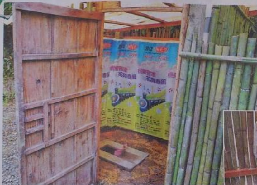
↑永安社區在玉龍泉生態步道設置環保廁所，全是在地取材及廢棄材料製成，一旁還放木屑及米糠，以便民眾使用後放入，有去味及發酵的功能。 一礦泉水保特瓶經過剪修，成為男性專用小便斗。
